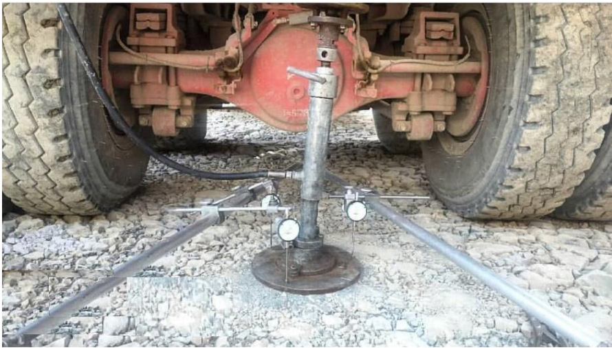
شکل پیوست ۱-۱- آزمایش بارگذاری صفحه به روش VSS
